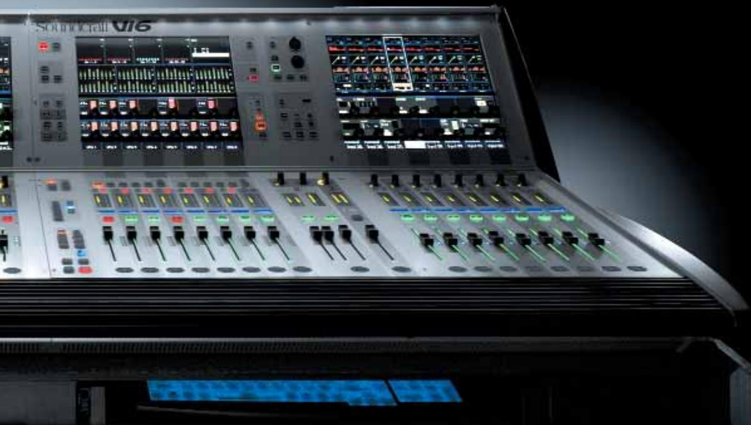
Drei Elemente bilden den Kern der Soundcraft Vi-Systeme: Die kompakte, Platz sparende Bedienoberfläche, das Local Rack mit der SCORE Live-Prozessoreinheit und die Stagebox mit ihren leicht zugänglichen Anschlüssen an das Local Rack über Cat5- oder Cat7- Kabel. Optional ist auch der Betrieb über Glasfaser möglich.
