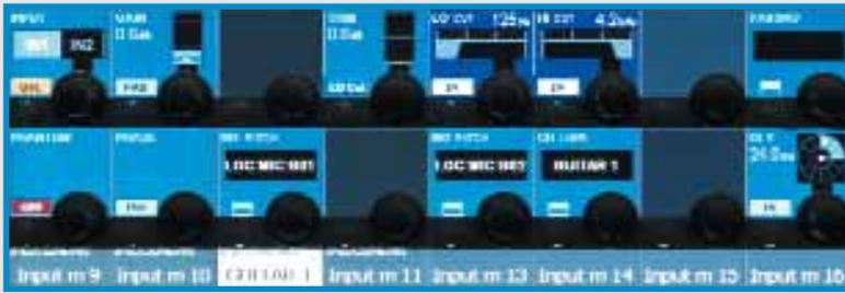
Der blaue Eingangs- und Routing-Bildschirm ermöglicht die Einstellung von Eingangsdelay, Mic-Gain, digitalem Trim, Frequenz der High- und Low-Pass-Filter, Kanal-Patching, Kanalbezeichnung und Stereo-Pairing.
