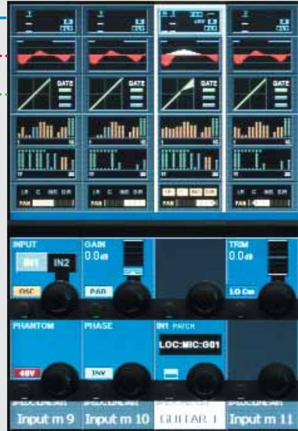
Die 16 Schalter und Drehgeber sind jeweils mit den entsprechenden Funktionen für den ausgewählten Modus belegt. Dank dieses einzigartig intuitiven Designs befinden sich sämtliche Einstellungsmöglichkeiten stets im Blickfeld des Tontechnikers.
