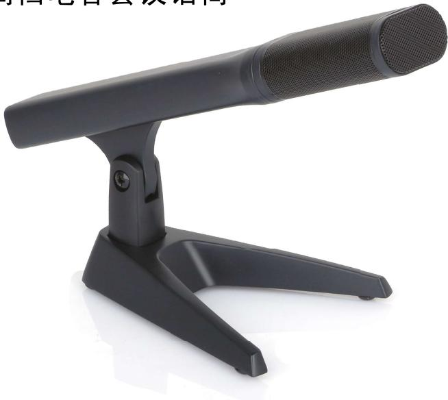
**CR990**是一款高级双音头阵列会议传声器，搭配两只完全独立的**14**毫米直径优质电容音头，有效拾音距离达**50**厘米以上（视声场环境而定）。音头采用横向阵列技术布置，精确控制纵向拾音角度，有效避免领桌干扰和声反馈现象的产生。精确计算的的蚀刻网罩技术结合干涉校正技术，能够清晰捕捉每个声音细节。独特的音头区域腔体设计，配合拾音校正技术，真实拾取每一个声音细节。特别设计的屏蔽线路和一体成型锌合金外壳能够有效抑制各类的电磁干扰，确保拾音清澈干净，满足高质量会议扩声需求。
